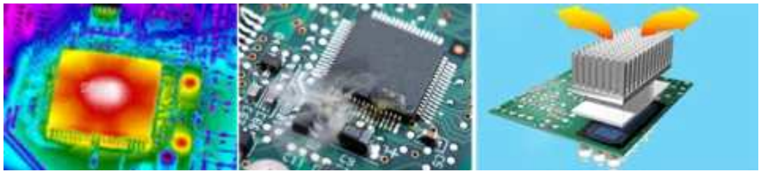
그림 1: 발열된 반도체패키징(좌, 중) 및 heat sink로 방열되는 부품(우)
